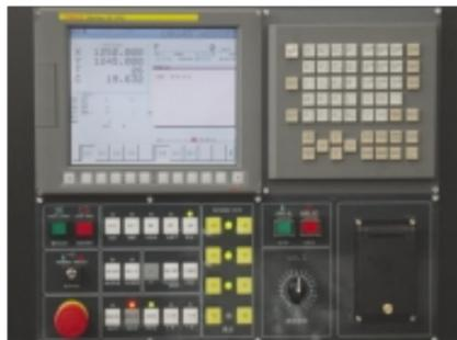
Un control numérico Fanuc con pantalla gráfica de 10,4" es toda una garantía de fiabilidad. Los servomotores digitales de c.a. son de la misma marca.
