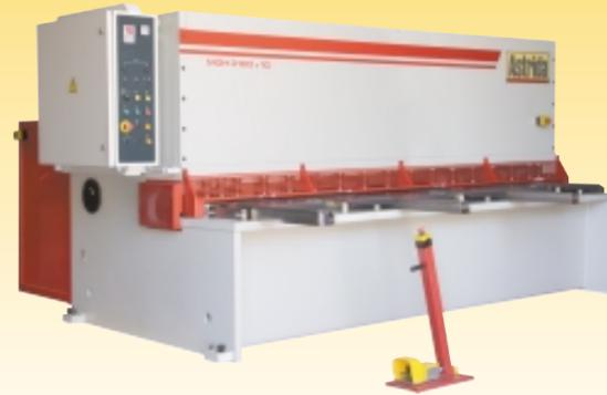
Cizallas de corte vertical y de corte pendular
