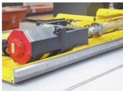
Equipada con grandes husillos de bolas transversales y guías lineales de alta precisión y fiabilidad, marca Bosch-Rexroth
