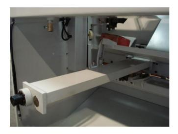
**Tope motorizado** de 1000 mm con husillo de bolas y abatible para cortar longitudes superiores a 1000 mm.
