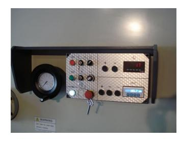
**Panel de mandos**. Digital mostrando el ángulo de corte. Digital mostrando la posición del tope. Volante con escala para modificar la separación entre cuchillas.
