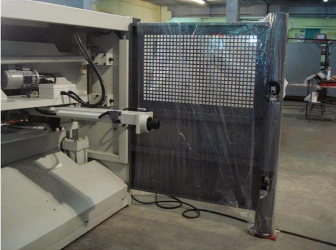
Una de las 2 **mamparas posteriores** de protección equipadas con células fotoeléctricas.
