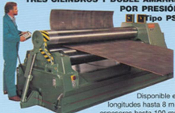
Disponible en longitudes hasta 8 m y espesores hasta 100 mm
