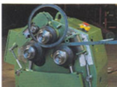
Curvado en espiral de barra plana de lado, utilizando un mecanismo opcional de calibración.
