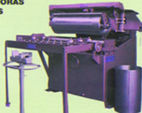
Máquinas automáticas para el curvado de pequeños depósitos, tubos y otros cilindros y segmentos.
